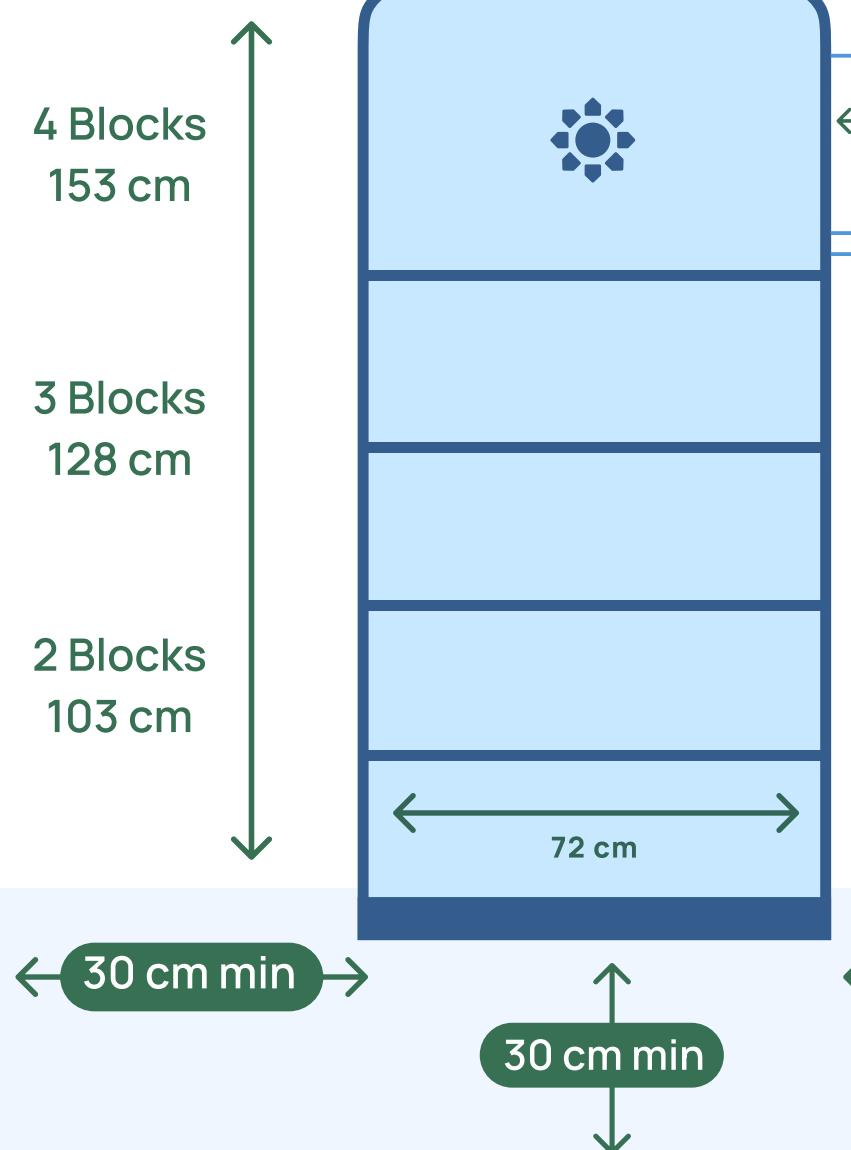
Les disjoncteurs des coffrets doivent être compris entre 50cm 180cm max de hauteur
